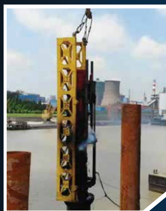
Thiết bị: Búa Diesel 2,5T Nước SX: Trung Quốc Số lượng: 06 Tính năng: Hạ cọc tròn DUL BTCT D350A
