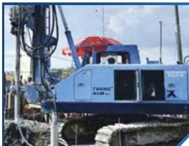
Thiết bị: Máy khoan cọc XMD Nước SX: Nhật Bản - Số lượng: 04 Tính năng: Khoan, phụt vữa gia cố nền móng
