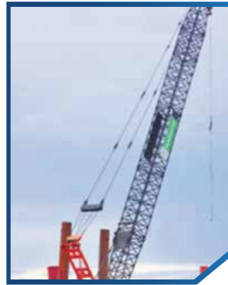
设备: 80吨履带起重机 产地: 日本 (Hitachi, Kobelco) 数量: 4台
