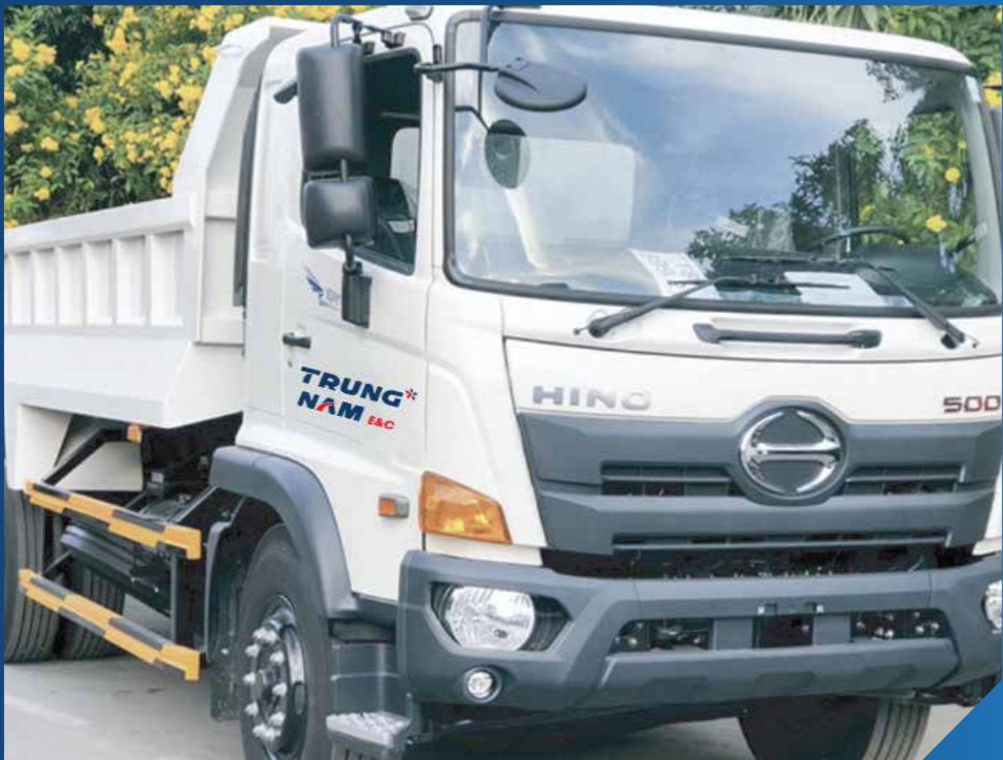
设备：自卸卡车 产地：日本、中国 数量：20辆 载重：12.5-15吨
