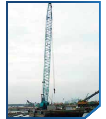
设备: 100-125吨履带起重机 产地: 日本 (Hitachi, Kobelco) 数量: 4台
