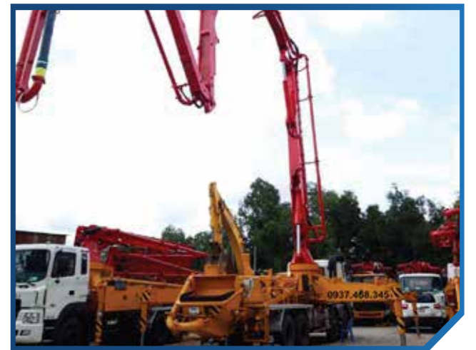
设备：混凝土泵车 (臂架式) 产地：韩国 - 数量：6台 生产能力：60-170立方米/小时 用途：混凝土泵送
