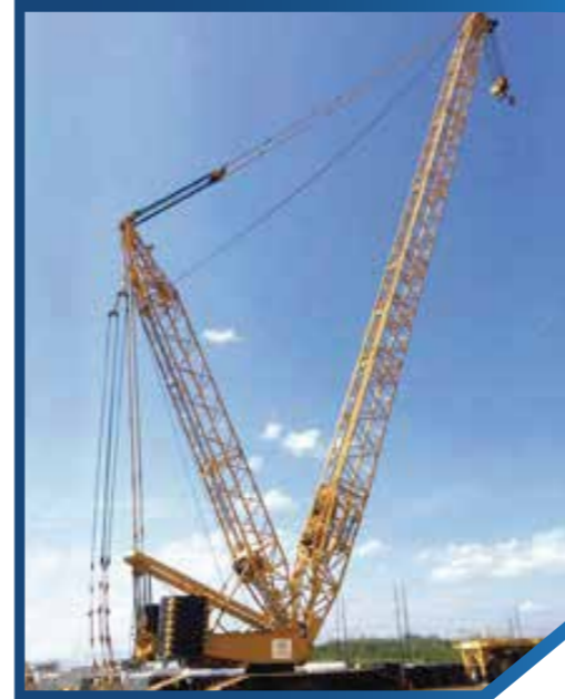
设备: 500吨履带起重机 产地: 日本 数量: 2台
