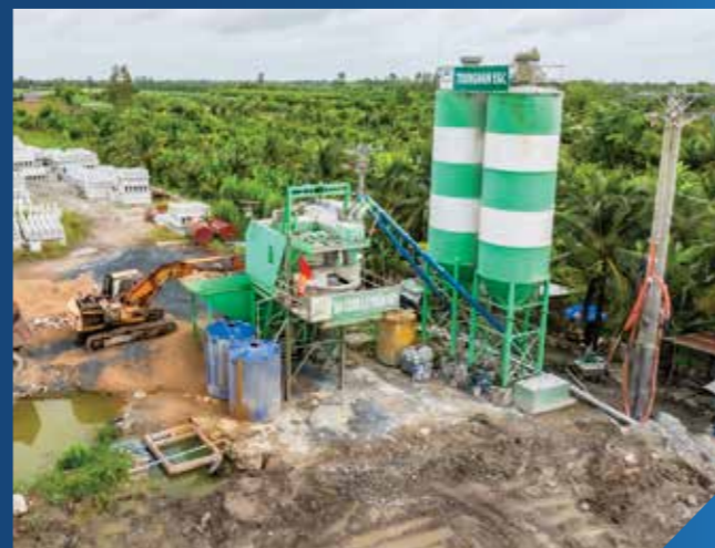
设备：混凝土搅拌站 产地：越南 - 数量：3套 生产能力：60-90立方米/小时 用途：混凝土拌合
