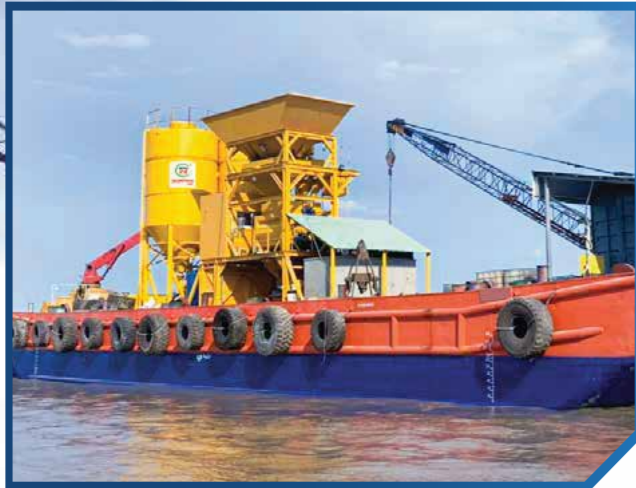
设备：浮式拌合站 产地：越南 - 数量：3套 生产能力：45-60立方米/小时 用途：水上混凝土拌合
