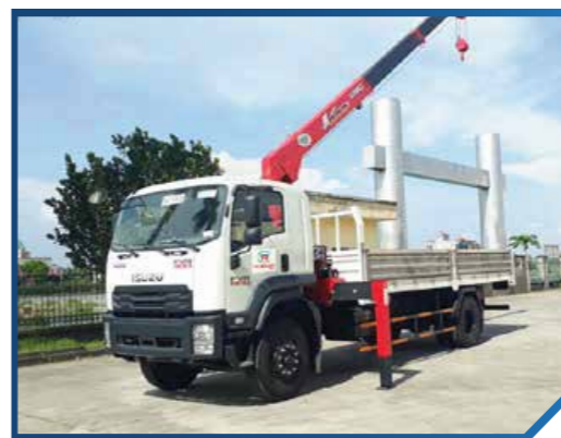
设备：随车起重机 产地：日本 数量：5辆 起重能力：15吨
