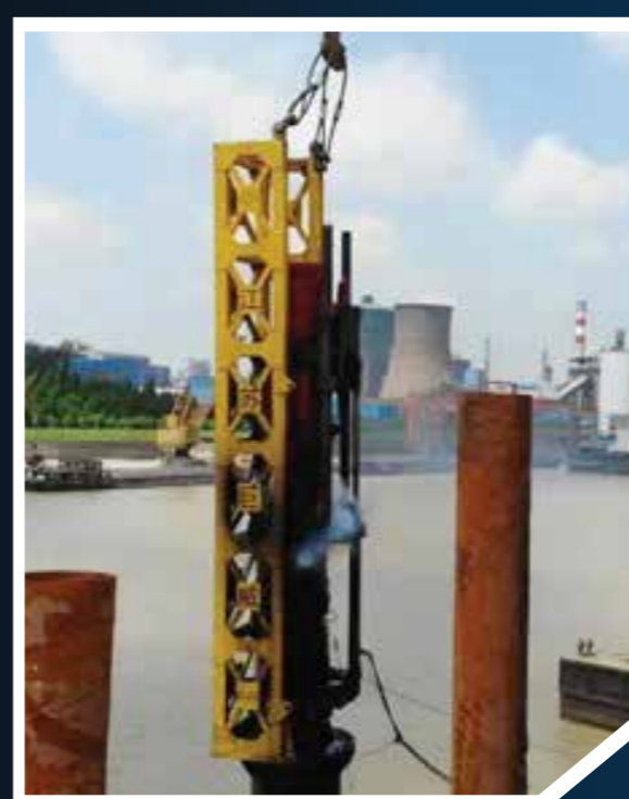
设备：柴油打桩锤 2.5吨 产地：中国 数量：6台 用途：沉桩施工（预应力混凝土桩 D350A）
