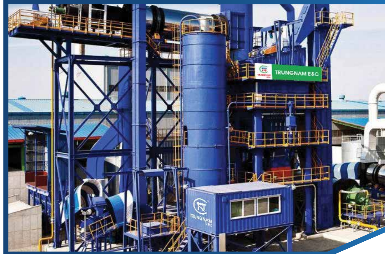
设备：沥青混合料拌合站 (Speco TSAP-2000FW 型) 产地：韩国 (2025年) 生产能力：160吨/小时
