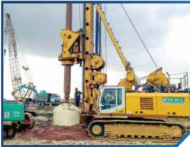
Thiết bị: Đầu khoan cọc nhồi Bauer (BG36) Nước SX: Đức Số lượng: 03
