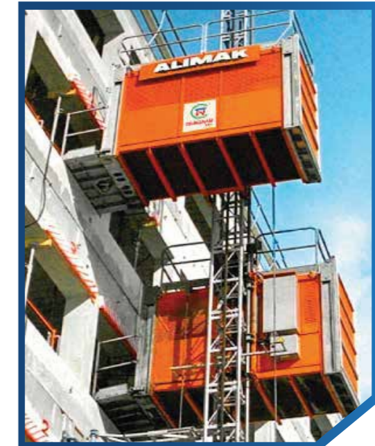
Thiết bị: Máy vận thăng Nước SX: Trung Quốc Số lượng: 03 Tính năng: Vận chuyển công nhân, vật tư lên cao
