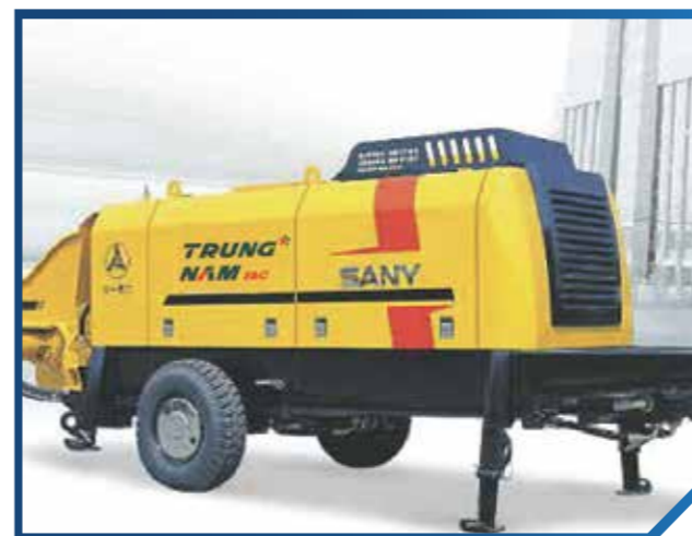
Thiết bị: Bơm tĩnh Nước SX: China - Số lượng: 04 Công suất: 60 - 90m 3 /h Tính năng: Bơm bê tông xi măng
