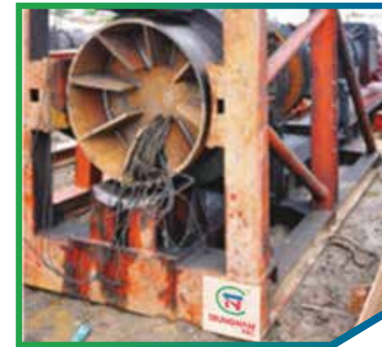
Thiết bị: Búa đóng cọc Nước SX: Trung Quốc Số lượng: 6 - 4 Công suất: 16 - 12T Tính năng: Hạ cọc ống thép SPSP, D1200, cọc BTLT
