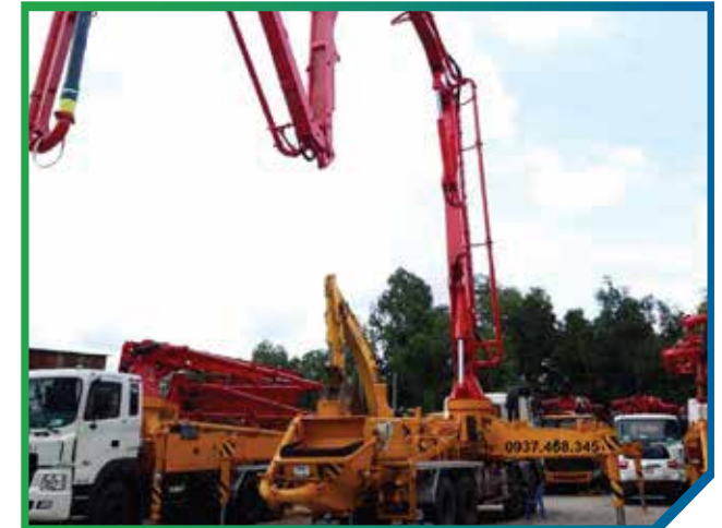
Thiết bị: Bơm cần Nước SX: Hàn Quốc - Số lượng: 06 Công suất: 60 - 90 - 170m 3 /h Tính năng: Bơm bê tông xi măng
