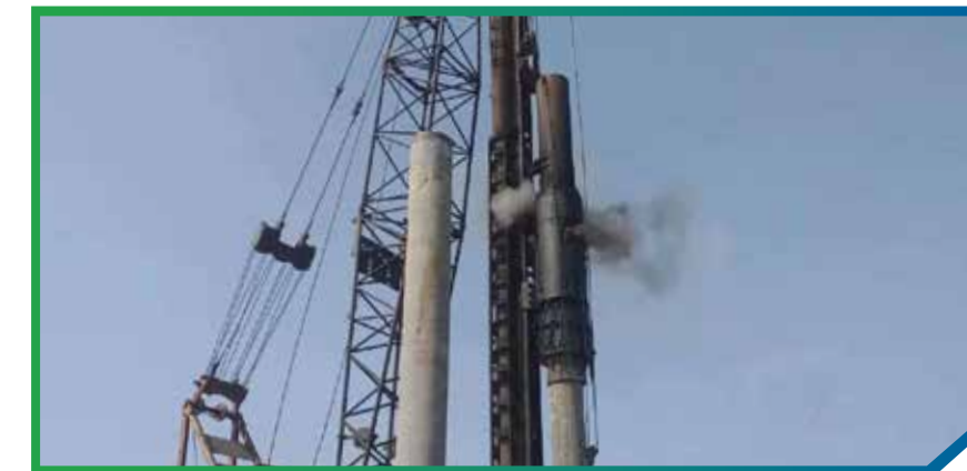
Thiết bị: Búa Diesel 3,5T Nước SX: Trung Quốc Số lượng: 10 - Tính năng: Hạ cọc tròn DUL BTCT D500A
